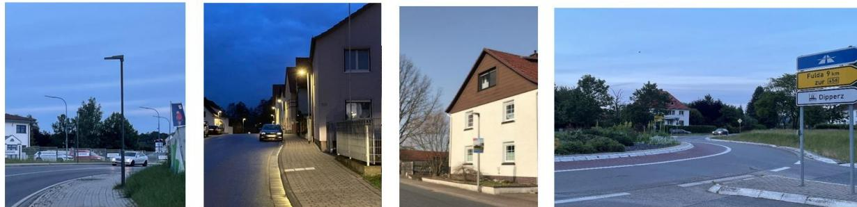
**Unten:** Optik der Leuchte: links Glocke statt technischer Leuchte, Mitte Mastkürzung Peitschenleuchte mit Glockenaufzett. Rechts und unten: Große Mastabstände und Nicht-Beleuchtung (siehe Kreisel) sind üblich und unproblematisch. Die Grenzwerte für Anwohner der Lichtimmissionsrichtlinie werden z.B. dadurch besser eingehalten; Kosten gesenkt.
