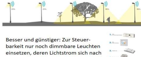
**Weniger Flächen beleuchten:** Gehweg statt Fahrbahn = niedrigere Masten, geringe Lichtströme und Reflexionen; Einsatz geeigneter Optiken, z.B. asymmetrisch breitstrahlend für gute Lichtverteilung. Rechts unten: gar nicht beleuchteten (Kreisel).
