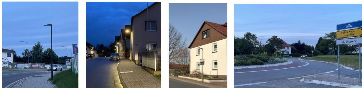
**Unten:** Optik der Leuchte: links Glocke statt technischer Leuchte, Mitte Mastkürzung Peitschenleuchte mit Glockenaufsatz. Rechts und unten: Große Mastabstände und Nicht-Beleuchtung (siehe Kreisel) sind üblich und unproblematisch. Die Grenzwerte für Anwohner der Lichtimmissionsrichtlinie werden z.B. dadurch besser eingehalten; Kosten gesenkt.
