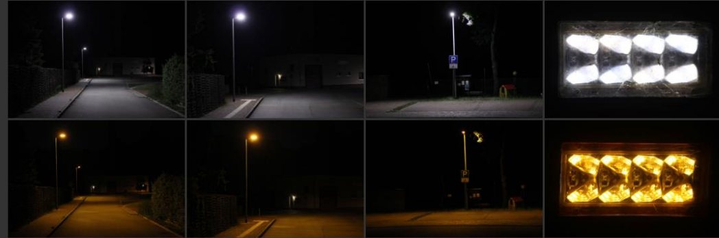
Die drei Leuchten vor und nach der Beklebung mit der Farbfilterfolie. Der Unterschied ist deutlich (identische Kameraeinstellungen).
